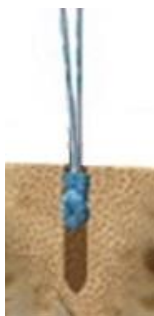
Figura 2 - Formação do aglomerado da âncora quando tracionada
